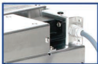
PSC - POWER SUPPLY CONNECTOR РАЗЪЕМ ДЛЯ ПОДКЛЮЧЕНИЯ ПИТАНИЯ
